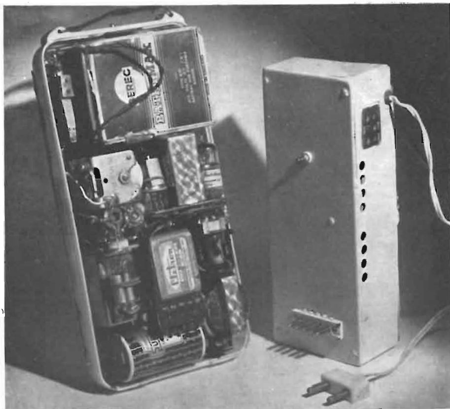
Aspetto generale del radoricevitore portatile con rigenerazione delle batterie di pile incorporate. A destra è il telaio racchiudente l'alimentatore in alternata.
