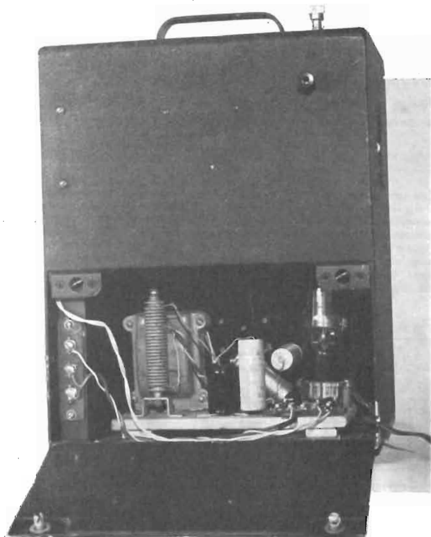
Vista posteriore del BC 221 con il circuito di alimentazione in corrente alternata incorporato
